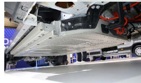
E-Transit wykorzystuje nadwozie spalinowego odpowiednika, ale cały spód jest „podbity” pojedynczym modułem bateryjnym o pojemności użytecznej 68 kWh. Zamiast sztywnego mostu z tyłu jest poprzeczny silnik napędzający koła zawieszane na wahaczach, ze sprężynami śrubowymi.
