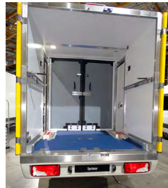
Zabudowa Carlsen Baltic CoolLite z elektrycznym agregatem Carrier Pulsor zasilanym całkowicie niezależnie od napędu samochodu, z baterii litowo-jonowej umieszczonej pionowo w narożniku nadwozia. Jest ona ładowana z sieci na każdym postoju, w w czasie jazdy z paneli słonecznych o łącznej mocy nominalnej 750 W. Nawet połowa energii potrzebnej do utrzymania temperatury może pochodzić ze słońca. Kierowca jest informowany o stanie i pochodzeniu energii na dodatkowym pulpicie przy lusterku.
