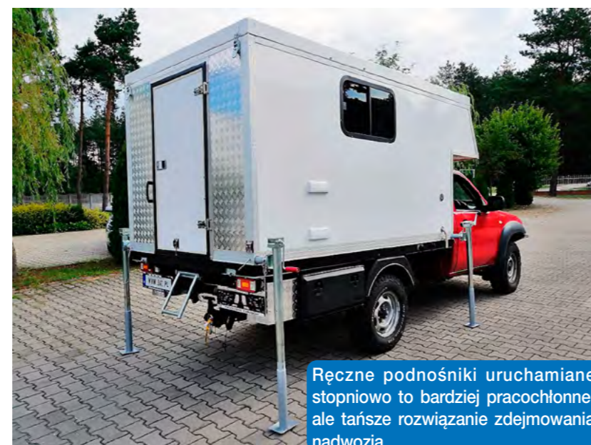
Mocna i przemyślana konstrukcja nadwozia umożliwia przewożenie dużej części wyposażenia na zewnętrznych stelażach.
