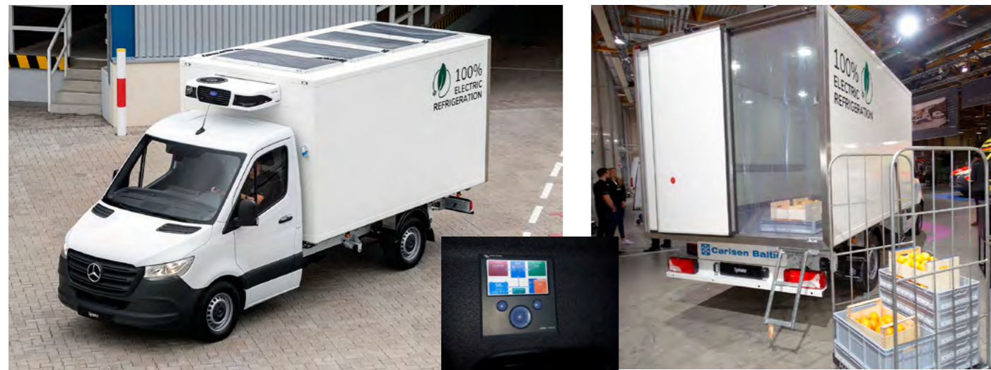
Zabudowa Carlsen Baltic CoolLite z elektrycznym agregatem Carrier Pulsor zasilanym całkowicie niezależnie od napędu samochodu, z baterii litowo-jonowej umieszczonej pionowo w narożniku nadwozia. Jest ona ładowana z sieci na każdym postoju, w w czasie jazdy z paneli słonecznych o łącznej mocy nominalnej 750 W. Nawet połowa energii potrzebnej do utrzymania temperatury może pochodzić ze słońca. Kierowca jest informowany o stanie i pochodzeniu energii na dodatkowym pulpicie przy lusterku.
