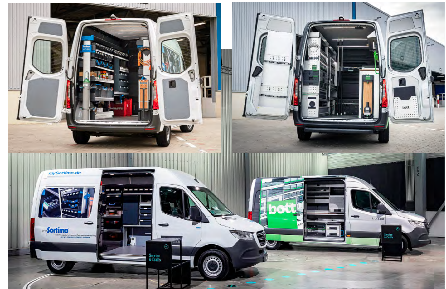
Takie same Sprintery 314 DCI z przednim napędem zabudowane nowymi systemami regałowymi Sortimo SR5 i Bott vario 3. W obu wprowadzono nowe zasady mocowania do nadwozia. Sortimowski już omawialiśmy, Bott połączył specjalne szczeliny kotwiczące w podłodze z typowymi szynami airline na ścianach. Oba systemy bardzo ułatwiają unieruchamianie większych przedmiotów przewożonych na podłodze. Vario 3 po raz pierwszy mieści typowe systemowe skrzynki narzędziowe. Może podobać się opcja oświetlenia paskami LED-owymi umieszczonymi w regałach.
