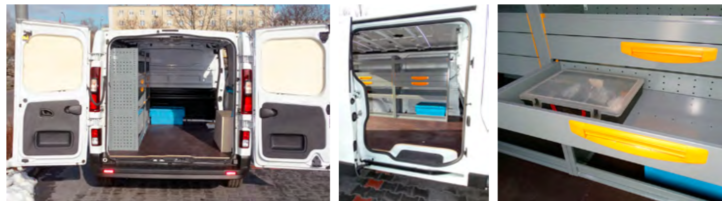
Wydłużone nadwozie ma ładownię o pojemności 6 m 3 i praktycznym kwadratowym przekroju. Wstawiono do niej 2-segmentowy regał warsztatowy z 6 półkami i 4 szufladami.
