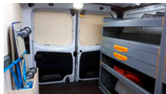
Wydłużone nadwozie ma ładownię o pojemności 6 m 3 i praktycznym kwadratowym przekroju. Wstawiono do niej 2-segmentowy regał warsztatowy z 6 półkami i 4 szufladami.
