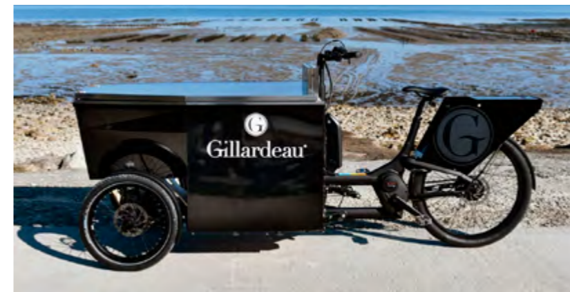
Trójkołowy ostrygowiec w pozycji transportowej. Stolik zabezpiecza blat roboczy i pojemniki przed otwarciem w czasie jazdy.
