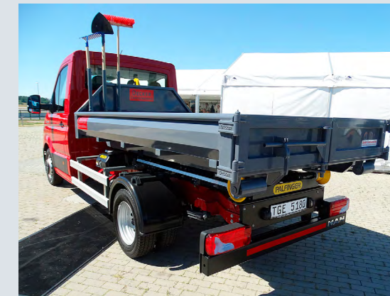
T 05 jest przystosowany do pojemników z uchmem na wysokości 920 mm. Zabezpieczenie przed wypadnięciem ucha jest grawitacyjne.
