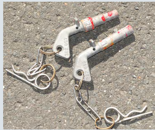
Sworznie blokujące przeguby wywrotki są nie do pomylenia nawet po ciemku, gdzie wchodzi „1”, a gdzie „2” można szybko zapamiętać.
