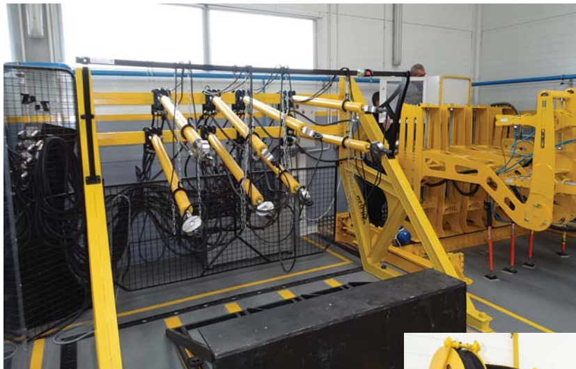
Urządzenie do badania wytrzymałości punktów kotwiczenia pasów bezpieczeństwa wg Regulaminu 14. Siła jest wywierana za pomocą znormalizowanych bloków.
