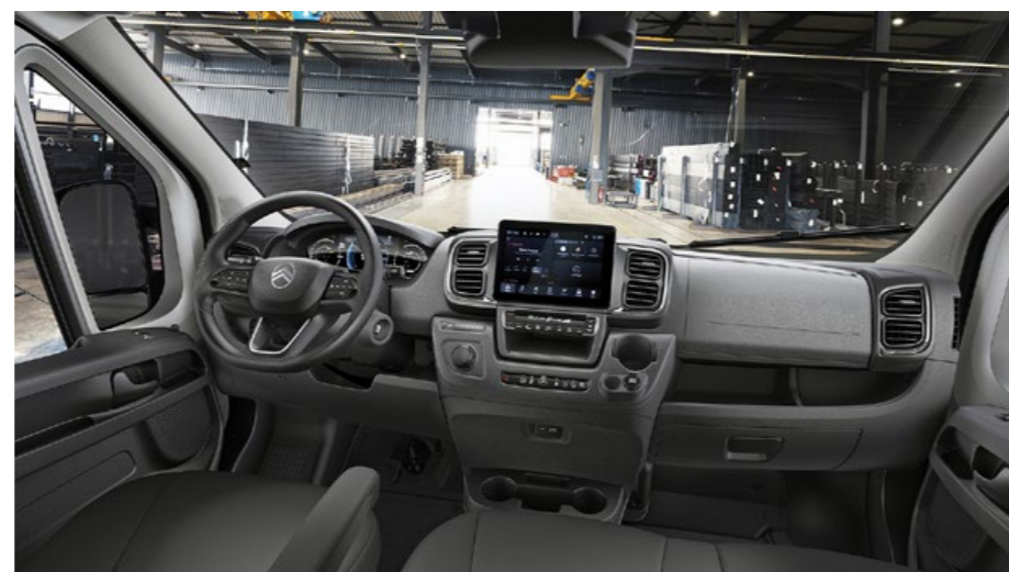
Układ tablicy przyrządów w dużych vanach Grupy też przypomina pierwotny dukatowski, w istocie jest jednak zupełnie nowa, podobnie jak kierownica, zestaw elektronicznych wskaźników, boczki drzwi. Pośrodku znajduje się obowiązkowy tablet 10", który może przydać się zwłaszcza przy współpracy z czujnikami przeszkód w otoczeniu (do 16 szt.!).
