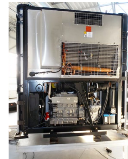
SLXi od tylnej strony, którą w naczepie przykrywają przednia ściana nadwozia i krata chroniąca parownik przed uszkodzeniem. Przez górny otwór jest wdmuchiwane zimne powietrze, opływające (prawidłowo rozmieszczony i zapakowany!) ładunek i wracające dolnym otworem wraz z odebraniem ciepła.
