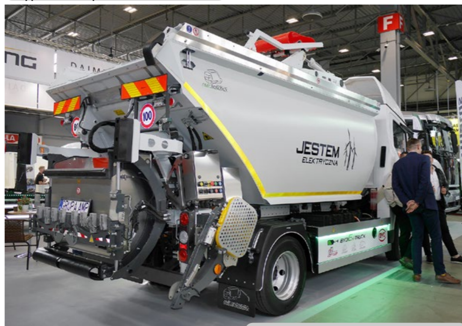
Ważną zaletą śmieciarki o załadunku tylnym/górnym AMP CRV MINI 8 e-power jest niezależny od podwozia napęd elektryczny funkcji zabudowy, co zwiększa zasięg i wydajność pojazdu.
