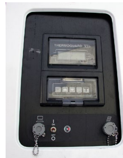
Thermoguard VI był klasyką układów sterujących dzięki interfejsowi ograniczonemu do kilku przycisków: Select do wyboru rodzaju wskazań wyświetlacza, strzałki do zmiany nastawionej temperatury i nawigowania między odczytami, enter do zatwierdzania. Przycisk z logo TK uruchamia diagnostykę agregatu.
