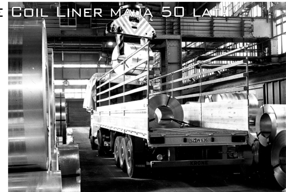
Pierwsza naczepa platformowa z rynną na kręgi została zaprezentowana przez Krone na targach IAA w 1973 r. Obecnie Coil Liner stanowi integralną część oferty firmy, dostępna w różnych konfiguracjach do każdego zastosowania.
