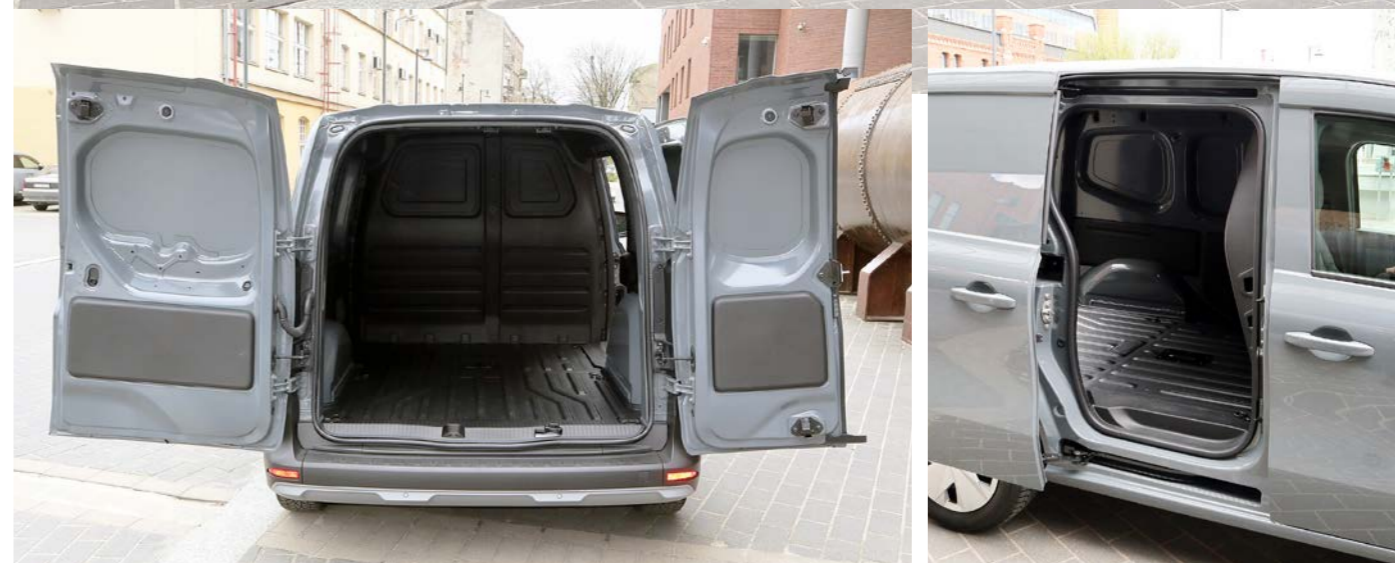
Jak na wymiary zewnętrzne samochodu (4486x1860x1804 mm) pojemność ładunkowa 3,3 m 3 jest umiarkowana. Zastrzeżenia budzi także kształt ładowni, która szybko zwęża się ku górze i praktycznie uniemożliwia wstawienie palety w poprzek. Dostęp przez boczne drzwi również nie zachwyca głównie za sprawą ścianki działowej, którą można było mocniej „wybrać” za pasażerem.
