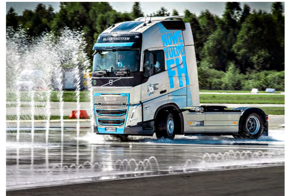
Szkolenie na torze Jastrzęb obejmowało jazdę na płycie poślizgowej w symulowanych trudnych warunkach drogowych. Nowoczesny ciągnik Volvo z układami ESP i Dynamic Steering czynnie wspomaga kierowcę przy wychodzeniu z opresji.
