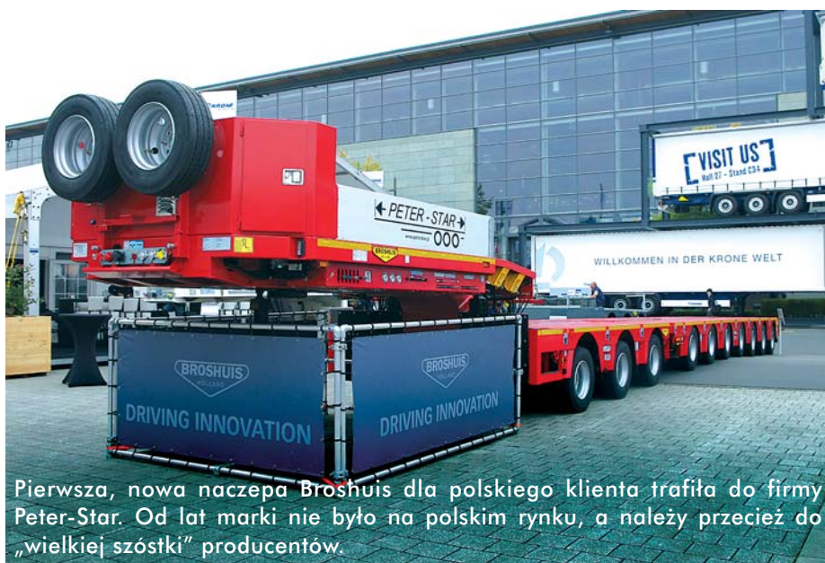
Rewolucja w świecie transportu ponadnormatywnego: zawieszenie pneumatyczne w miejsce hydraulicznego. Nie wiadomo, czy i na ile przyjmie się na rynku, ale pomysł ciekawy.
