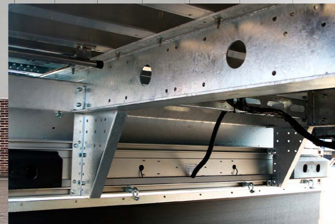
Rama naczep Kraker może być tradycyjna spawana i wtedy jest cynkowana ogniowo, lub także skręcana z elementów giętych ze stali o wysokiej wytrzymałości.
